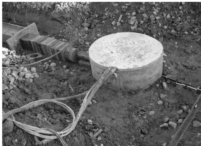
<그림 4.4> 수평재하시험 전경
