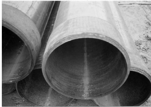
<그림 9.3> 외벽 평면형 보강밴드가 부착된 개단 강관말뚝
