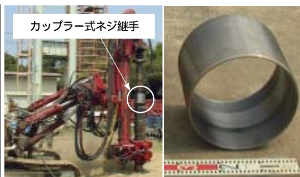
図-2.4.1 カップラー式ネジ継手の一例
