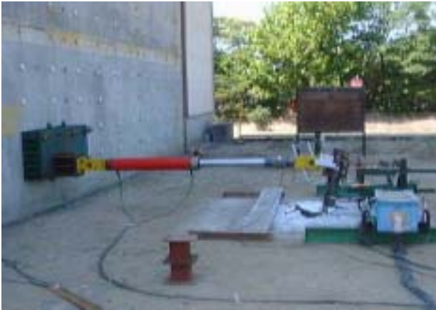
図-2.2.15 水平交番載荷試験全景
