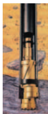
削孔時( 偏芯拡径 )
