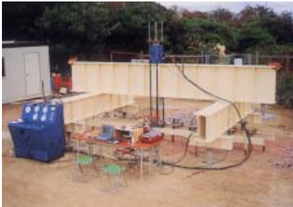
図-2.2.13 鉛直載荷試験状況 5)
