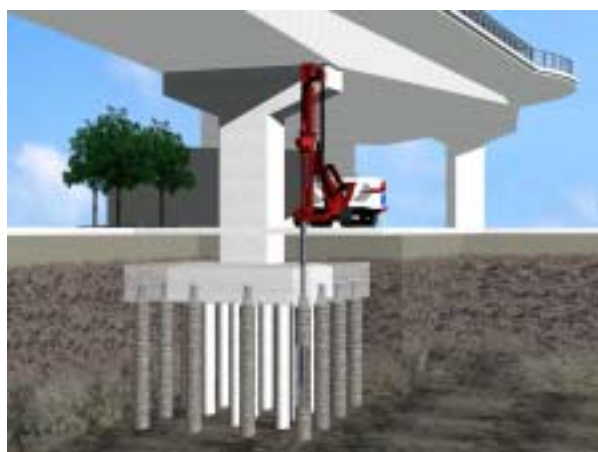
図-3.1.2 既設構造物基礎の補強増し杭 17) (ST マイクロパイル タイプ )
