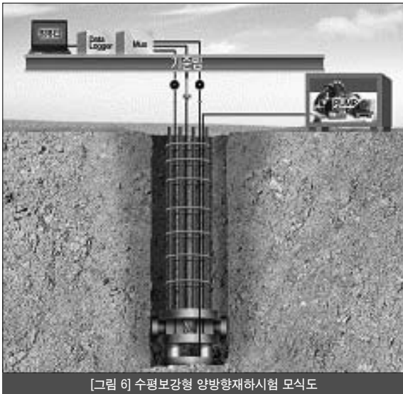
[그림 6] 수평보강형 양방향재하시험 모식도
