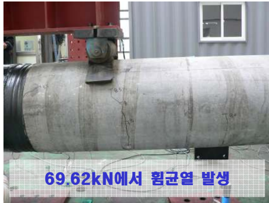
PHC 균열 발생
