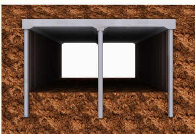
④ 내부 굴착 및 방수철판 설치
