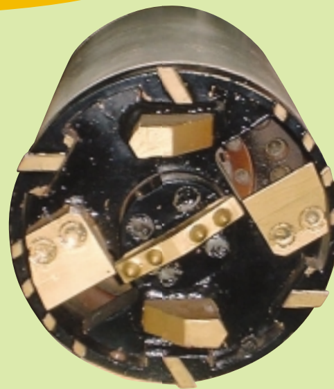
調整機構付ビットカッターヘッド
