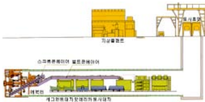
<Fig 2.11> 토압식 쉴드TBM 공법의 개요도
