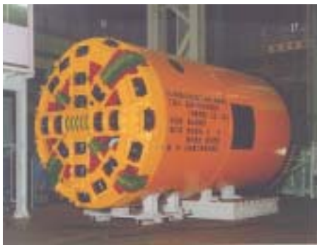
<Fig 2.10> 토압식 쉴드TBM장비와 구조도
